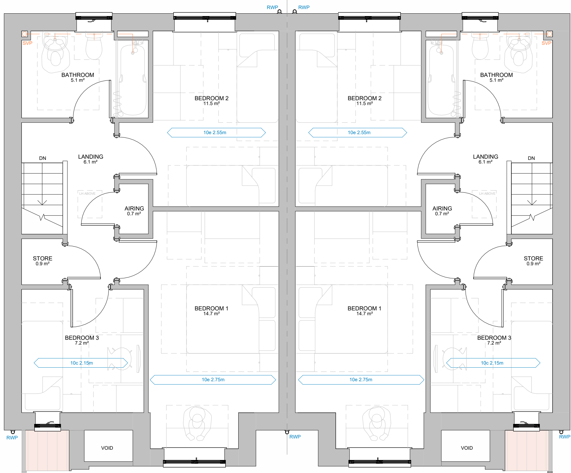
BLOCK TYPE DD - FIRST FLOOR PLAN 1 : 50
