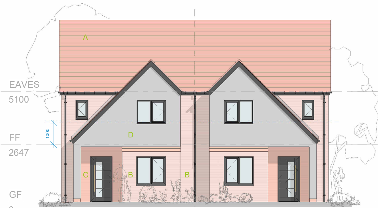
BLOCK TYPE DD - FRONT ELEVATION 1 : 100
